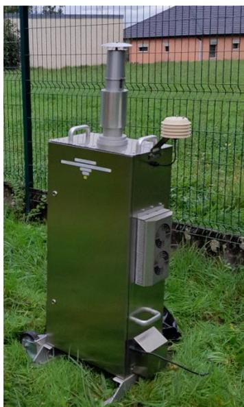
Les concentrations atmosphériques des métaux contenus dans les poussières sont mesurées à l'issue de la spéciation chimique des PM10. l'analyse chimique en laboratoire conduit à une valeur moyenne (concentration des polluants gazeux) pendant la durée d'exposition.
