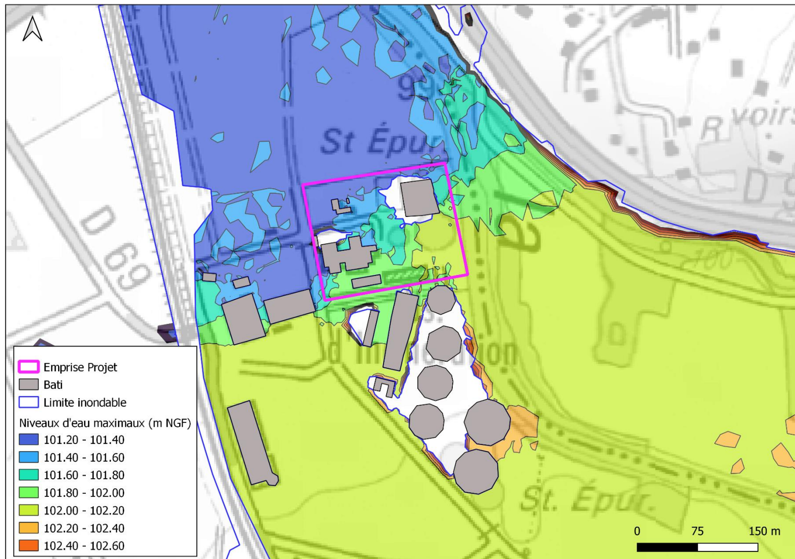
Figure 7 : Etat actuel - Niveaux d'eau maximaux
