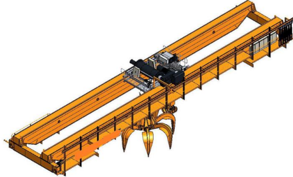
Figure 9 : exemple de pont-roulant OM
